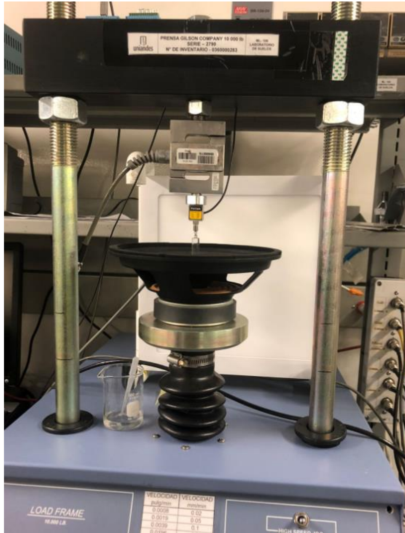
Figura 3. Prensa Gilson con esferas posicionadas correctamente y panel LED a contraluz.
