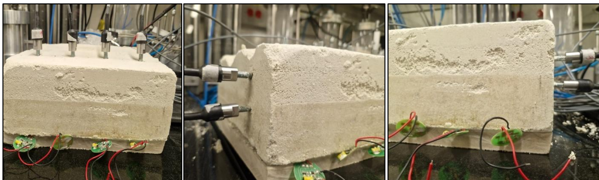
Figura 2. Disposición superficial de acelerómetros en el bloque experimental.
