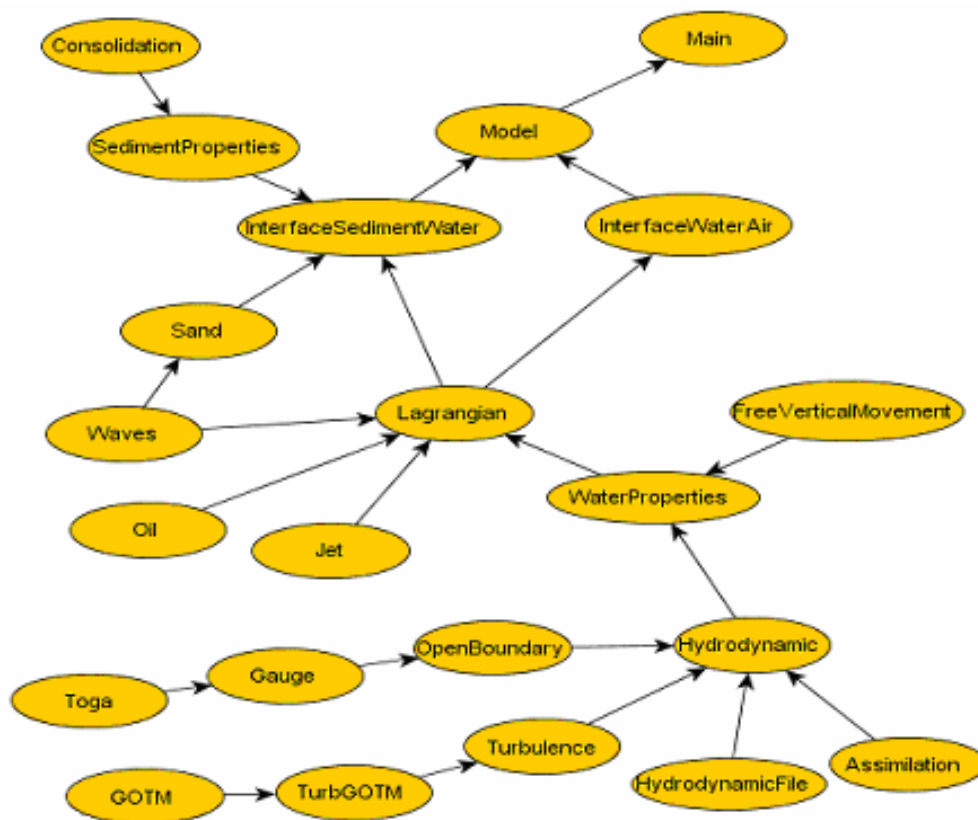
Figura 2-5 Relación de dependencia entre módulos de MOHID Water [Barreto et al. 2009].
