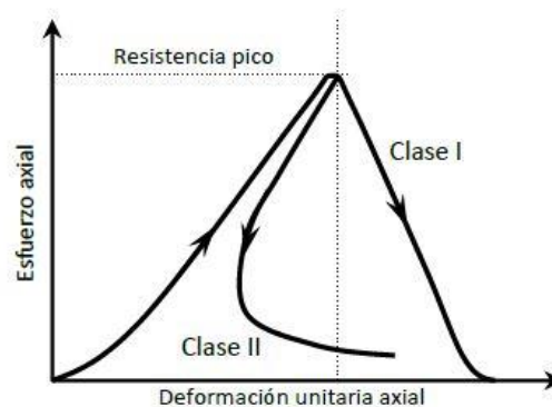
Figura 3.8: Curvas esfuerzo vs deformación clase I y clase II
