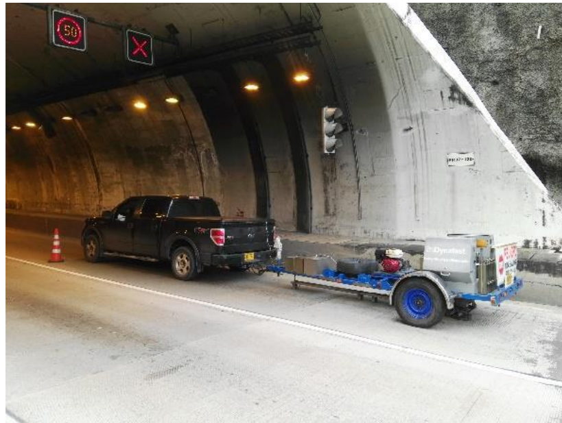
Figura 4.12: Ejecución del Deflectómetro de impacto FWD
