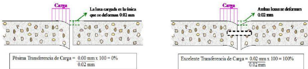
Figura 4.18: Ejemplos de transferencia de carga, a la izquierda una eficiencia nula y la derecha una eficiencia óptima.
