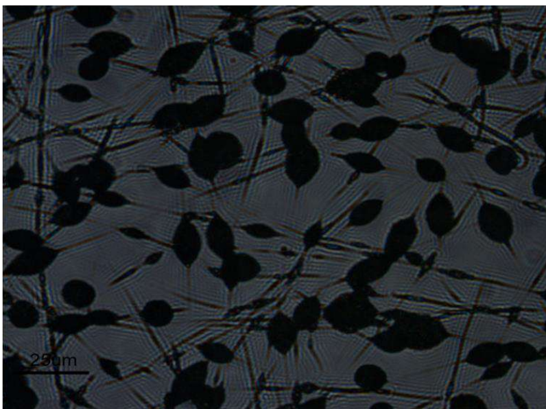
Fotografías con microscopio electrónico a 25μm (400x), de las microfibras aleatorias obtenidas a partir de los polidroxialcanoatos extraídos de las fermentaciones de los residuos de cascara de yuca.
