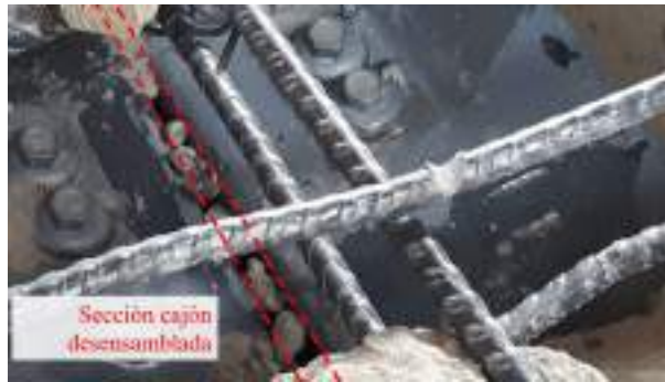
Figura 2-24: Separación de perfiles CFS en la sección cajón ensamblada en ensayo experimental de vigas compuestas con tornillos como fijación de conectores.
