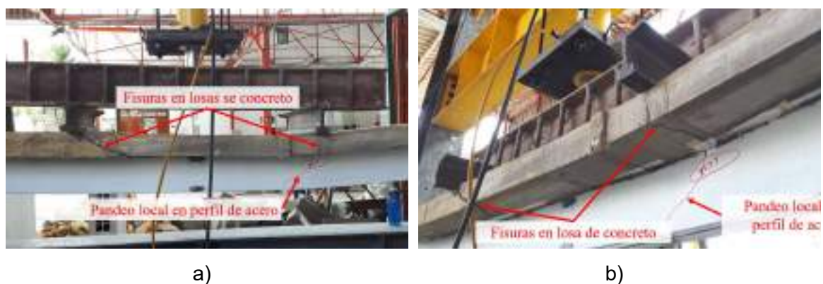
Figura 2-20: Fractura de placa de concreto en ensayo experimental de vigas compuestas con tornillos como fijación de conectores. a) Vista general. b) Detalle.
