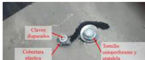
Figura 2-13: Sistemas de sujeción instalados en probetas experimentales. Vista superior.
