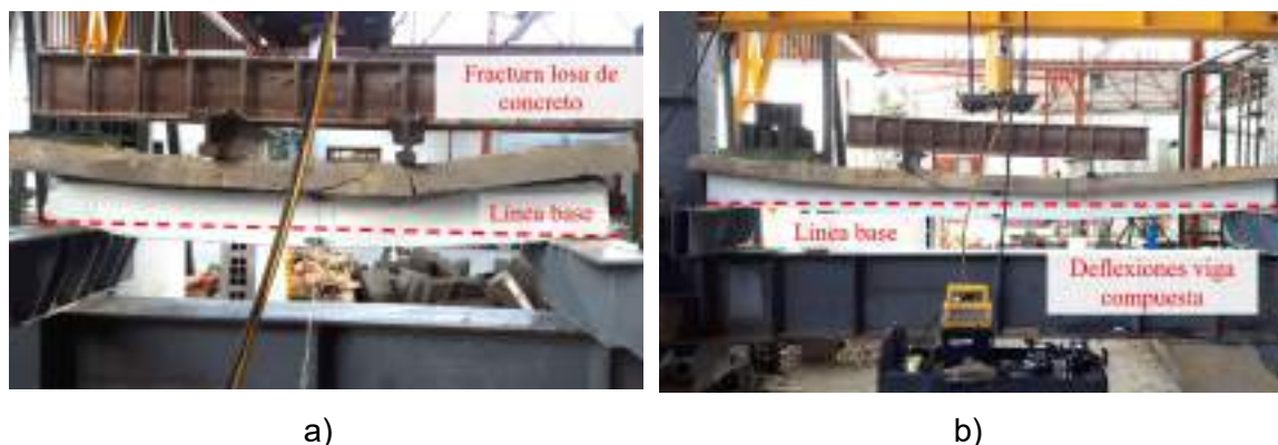
Figura 2-17: Estado final de las probetas en ensayo experimental de vigas compuestas con tornillos como fijación de conectores. a) Vigas de 2m de longitud. b) Vigas de 4m de longitud.
