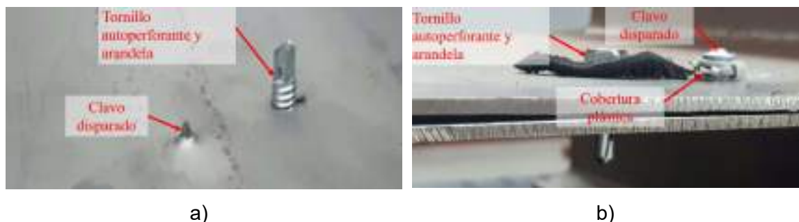
Figura 2-14: Sistemas de fijación instalados en probetas experimentales. a) Vista inferior. b) Vista frontal.
