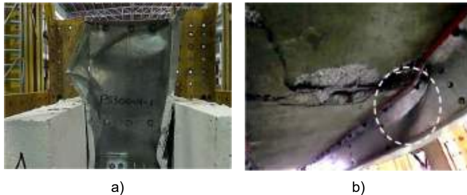
Figura 2-2: Condición de pandeo local en secciones compuestas de concreto y perfiles CFS. a). Ensayo de corte directo (Push-Out test). b). Ensayo de vigas a escala real.
