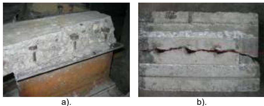
Figura 1-16: Mecanismo de falla por fractura longitudinal en el concreto (Splitting). a). Placa fracturada remanente en el espécimen de ensayo. b). Placa fracturada por el eje de localización de conectores.
