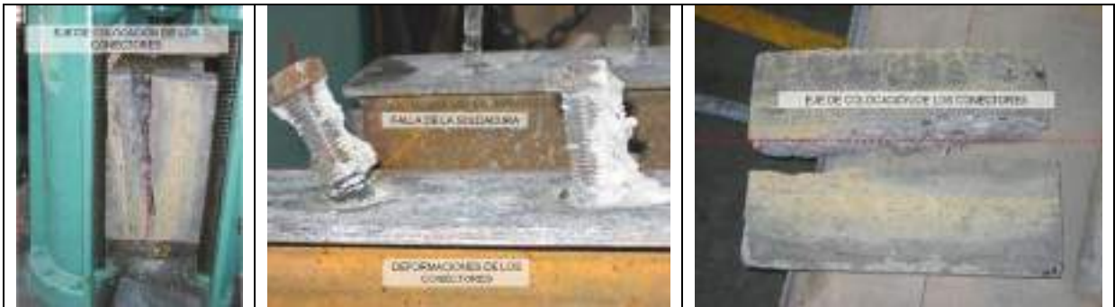
Figura 3.32 Falla típica de las probetas M6-2-12
