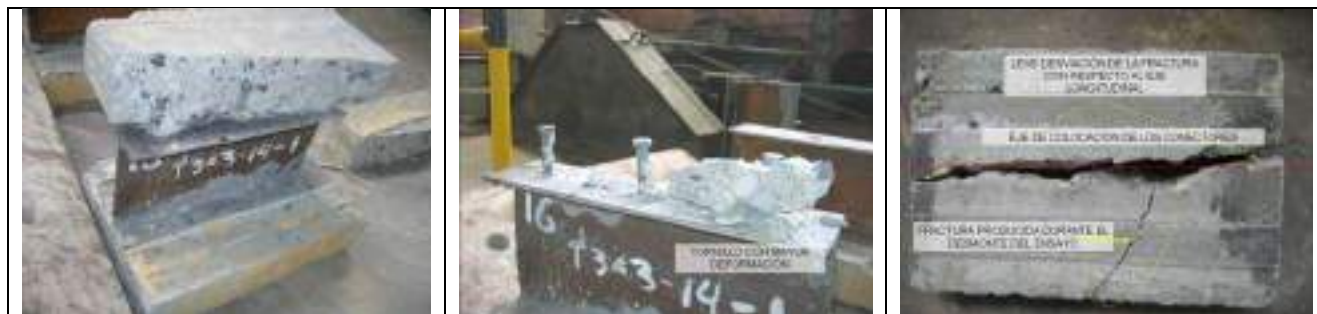
Figura 3.13 Falla típica de las probetas M4-3-14
