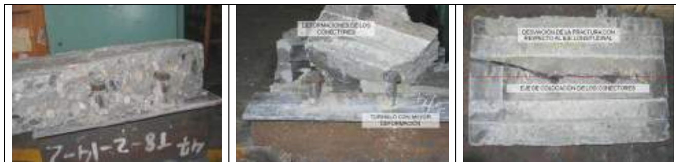
Figura 3.34 Falla típica de las probetas M6-2-14
