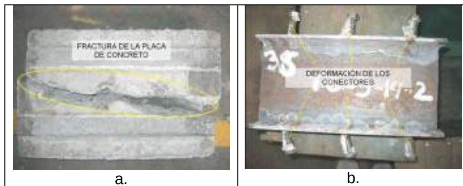
Figura 4.7. Trabajo conjunto de los materiales. a) Concreto. b) Tornillos.
