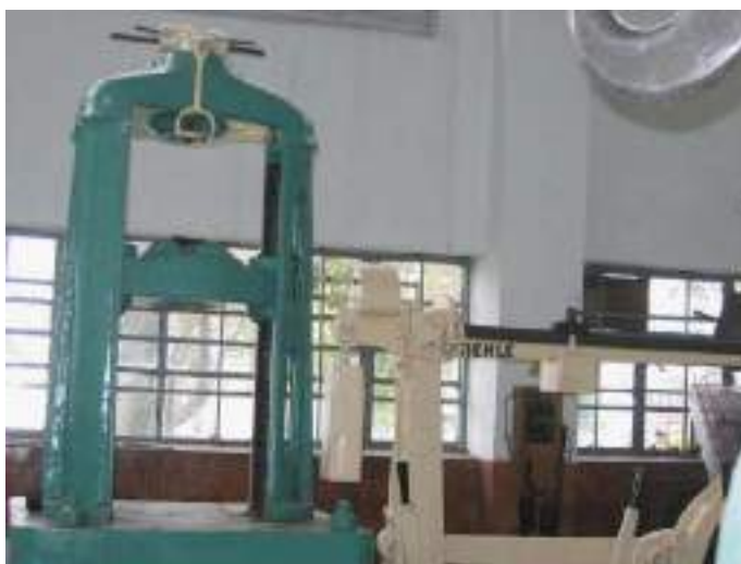
Figura 2.2 Máquina de aplicación de carga
