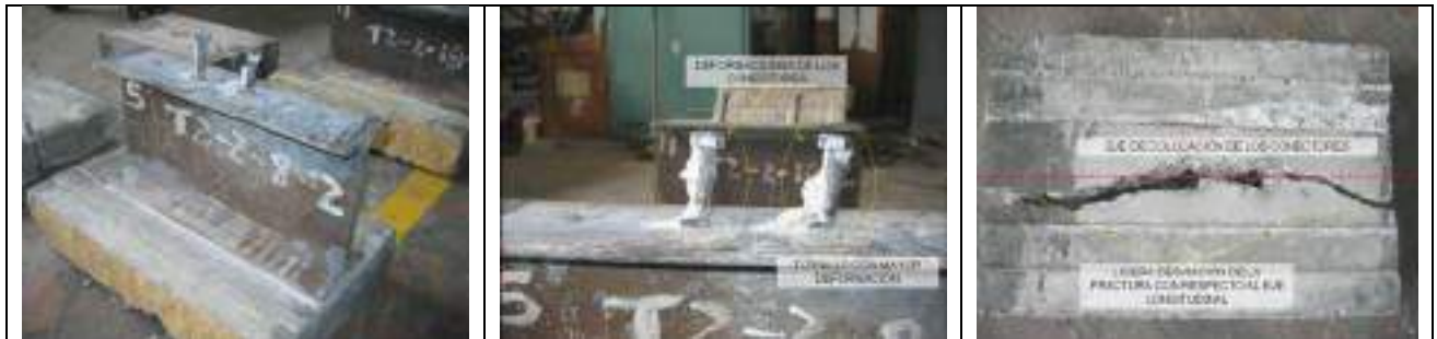
Figura 3.3 Falla del concreto de las probetas M4-2-8-2 y M4-2-8-3
