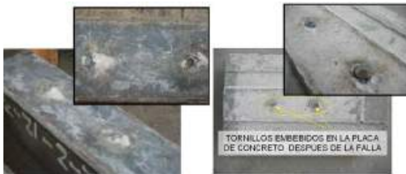
Figura 3.6 Falla de la soldadura de las probetas M4-2-12-2 y M4-2-12-3
