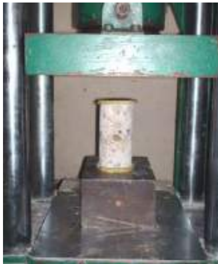
Figura 2.4 Ensayo de compresión simple en el concreto.
