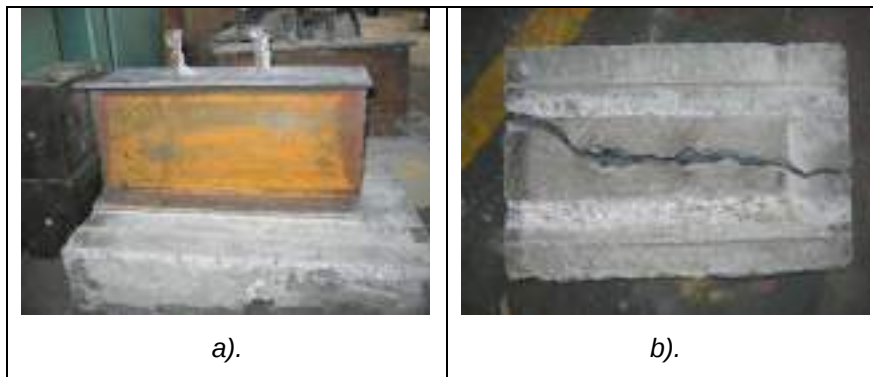
Figura 6.25. Comportamiento conjunto del modelo M5-2-12. a) Deformación de los conectores. b) Fractura de la placa de concreto.
