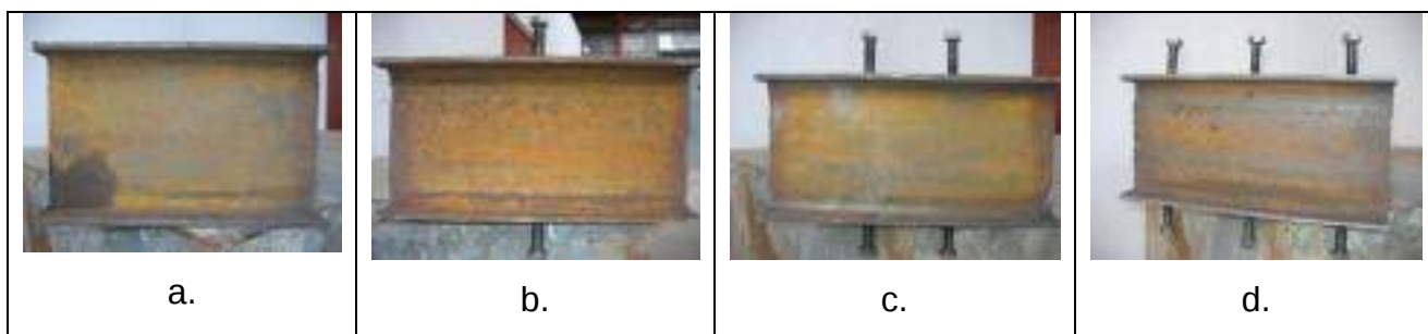
Figura 2.9 Perfiles metálicos antes de la fundida. a) Probeta sin tornillos. b) Probeta con un tornillo. c) Probeta con dos tornillos. d) Probeta con tres tornillos.
