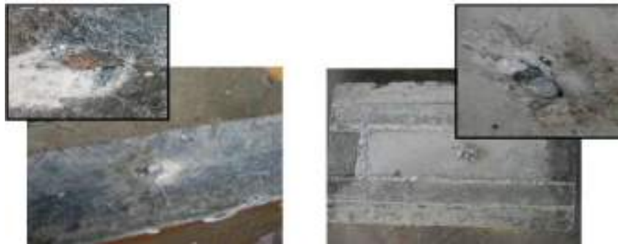
Figura 3.1 Falla típica de las probetas M4-1-0
