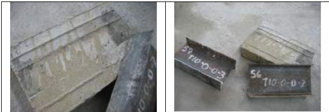
Figura 2.14 Probetas sin conector las cuales se soltaron durante el desformaleteado
