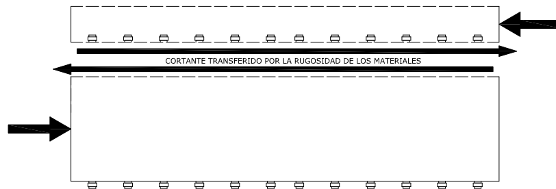
Figura 1.8. Transferencia de cortante por rugosidad en la interfase
