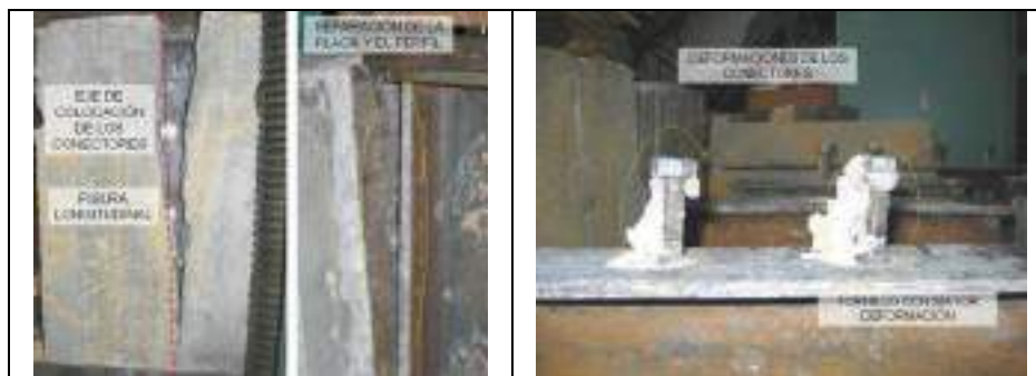
Figura 3.19 Falla típica de las probetas M5-2-12
