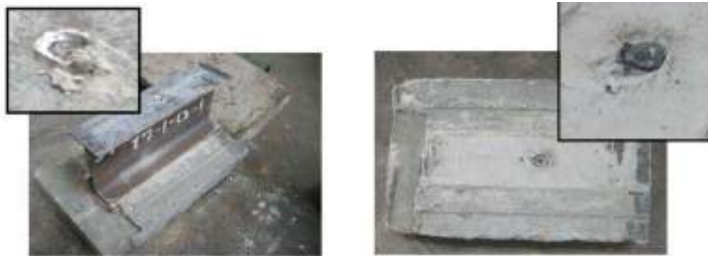
Figura 3.27 Falla típica de la soldadura de las probetas M6-1-0-1 y M6-1-0-2
