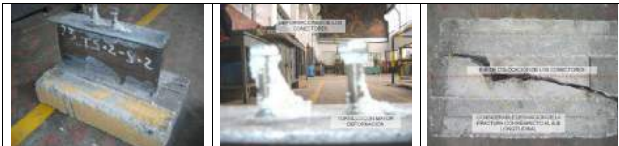
Figura 3.17 Falla típica de las probetas M5-2-8
