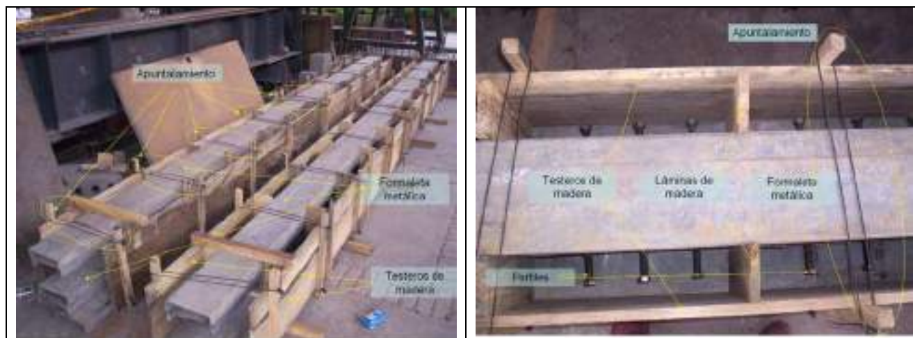
Figura 2.11 Formaleta empleada para la elaboración de las probetas.
