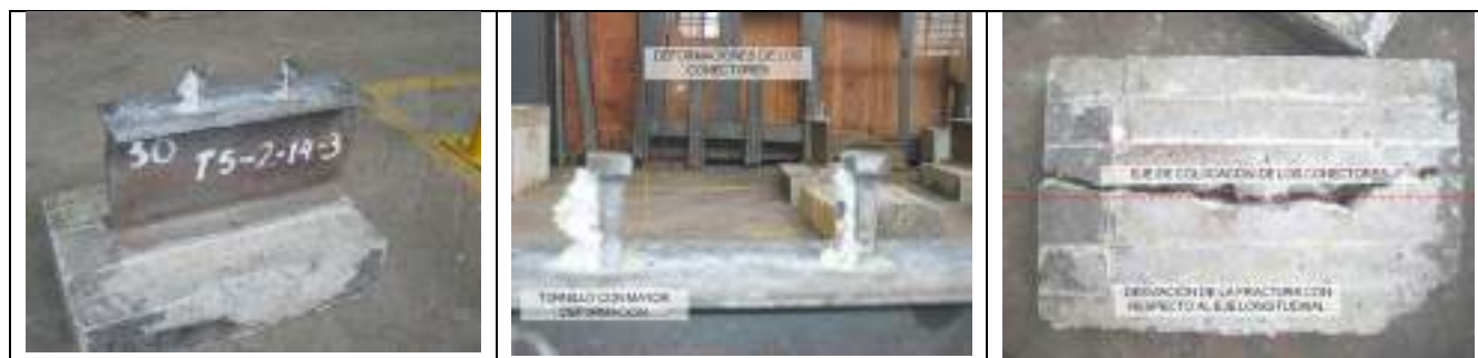
Figura 3.21 Falla típica de las probetas M5-2-14
