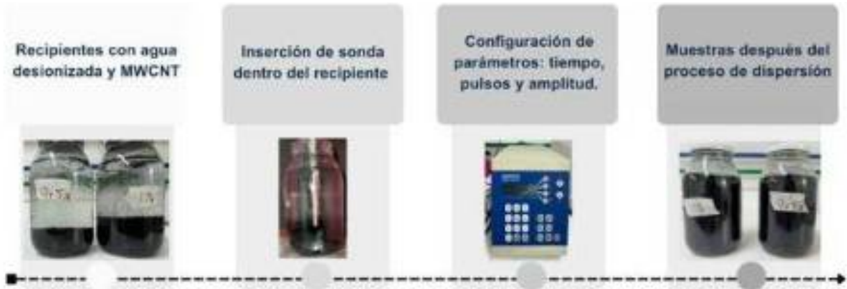
Figura 3-37. Procedimiento de dispersión por sonda ultrasónica.
