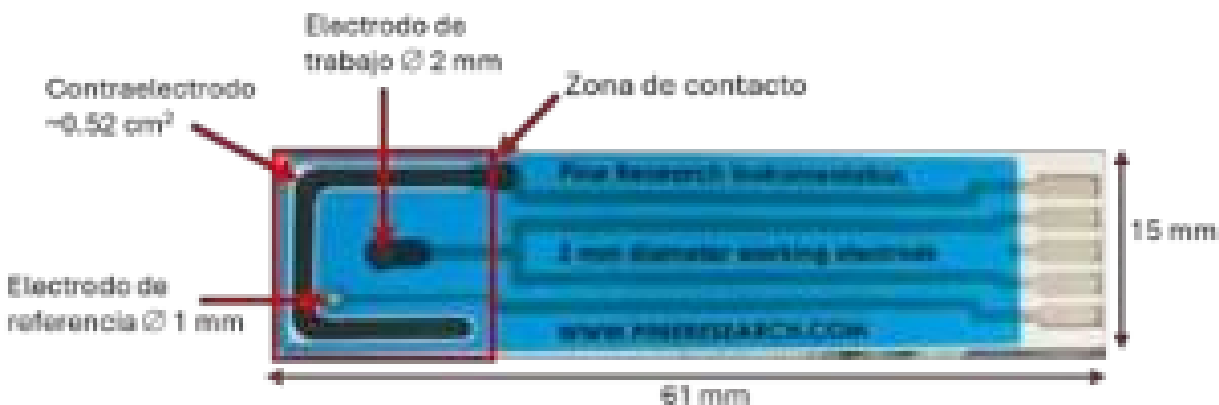
Figura 3-24. Electrodo serigrafiado en PET con tinta impresa de carbono.
