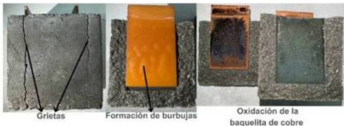
Figura 3-46. Efecto de la oxidación en baquelitas de cobre embebidas en el mortero.
