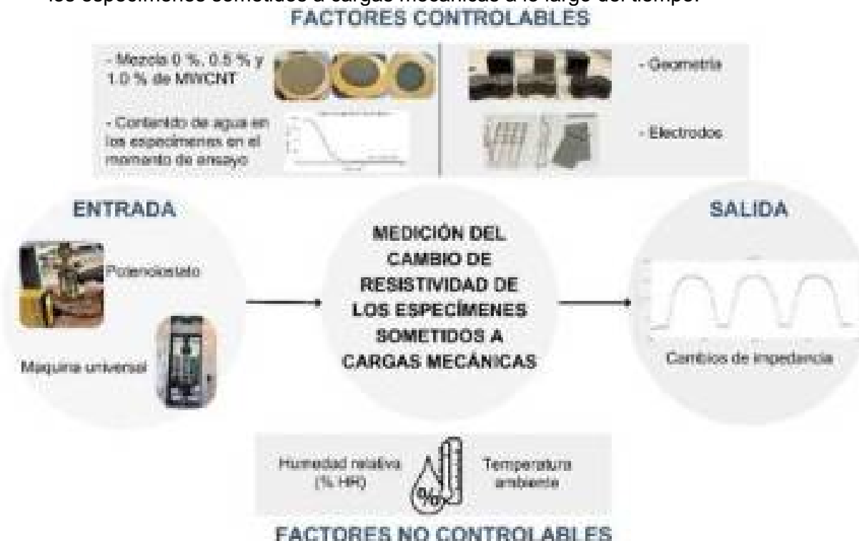
Figura 3-31. Esquema del diseño experimental para evaluar la variación de resistividad en los especímenes sometidos a cargas mecánicas a lo largo del tiempo.
