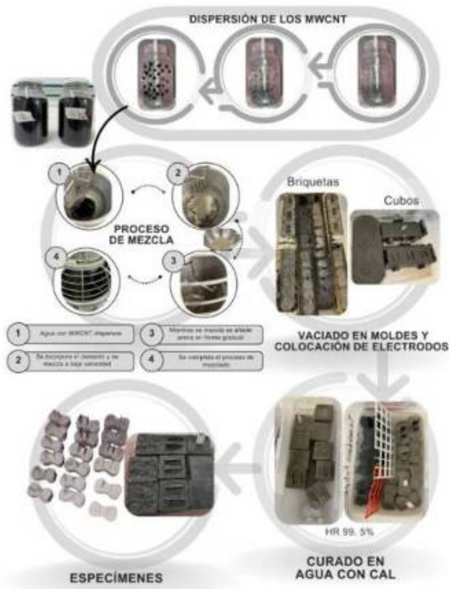
Figura 4-9. Esquema del procedimiento para la elaboración de especímenes con MWCNT para mediciones de respuestas eléctricas ante cargas mecánicas.
