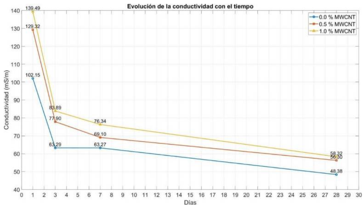
Figura 4-20. Evolución de la Conductividad Eléctrica en Morteros con Diferentes Porcentajes de MWCNT.
