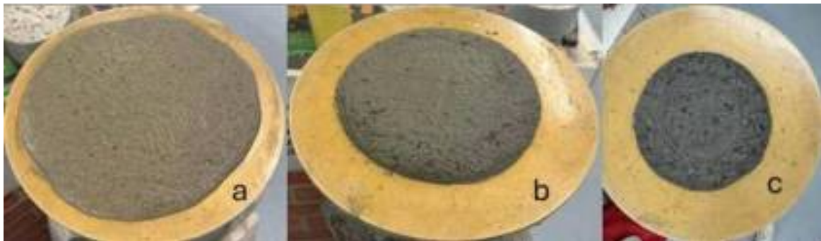
Figura 4-10. Variación de la fluidez según el contenido de MWCNT, 0.0 % (a), 0.5 % (b) y 1.0 % (c).
