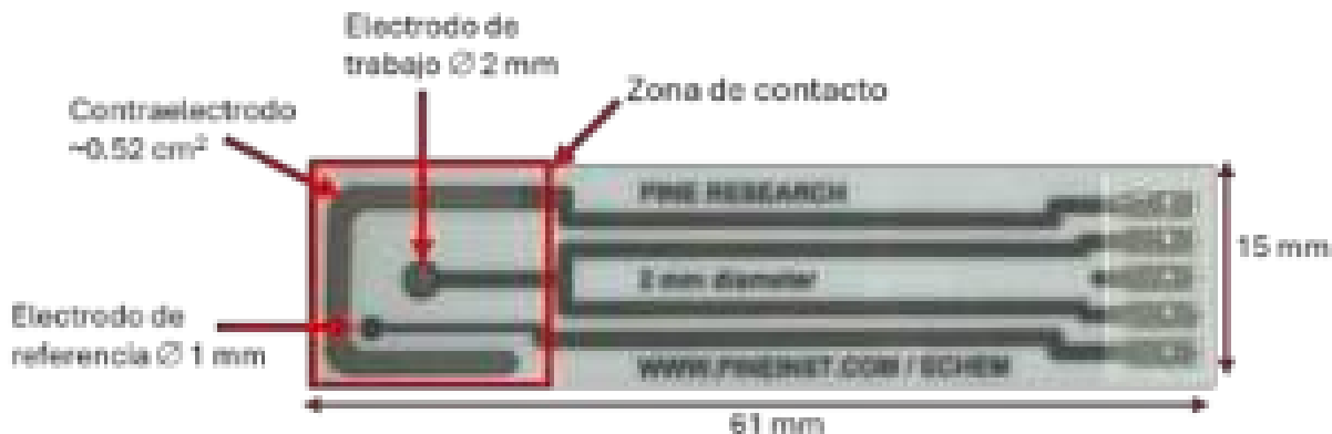
Figura 3-25. Electrodo serigrafiado en cerámica con tinta impresa de platino.
