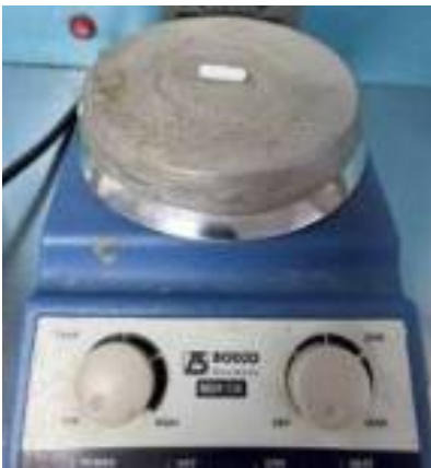
Figura 3-5. Agitador magnético con placa calefactora Boeco MSH 130 y barra de agitación magnética.
