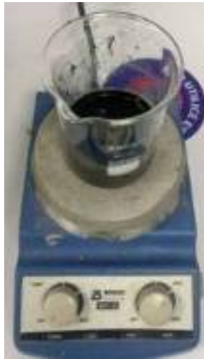
Figura 3-32. Método manual de dispersión, uso de agitador magnetico.
