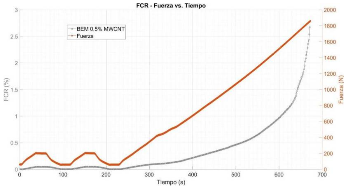
Figura 4-66. FCR vs tiempo: electrodo de malla de alambre (BEM), tensión hasta la falla.
