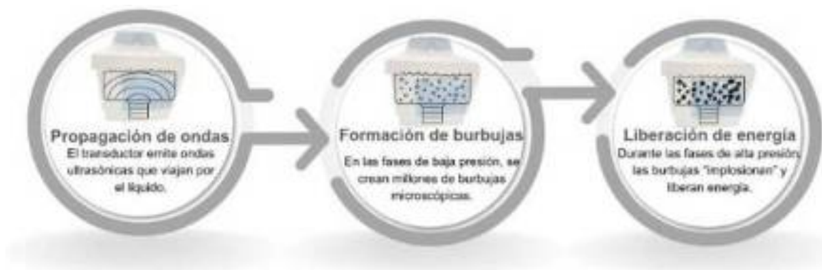
Figura 3-34. Principios de operación de un baño ultrasónico.
