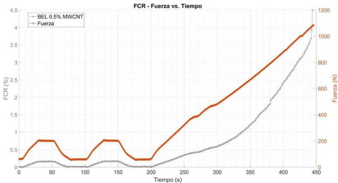
Figura 4-68. FCR vs tiempo: electrodo de lámina de acero (BEL), tensión hasta la falla.
