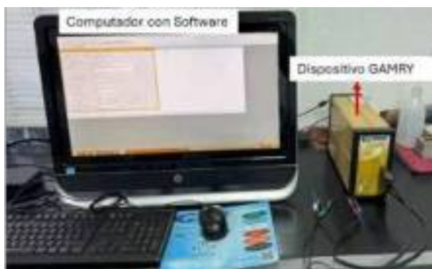
Figura 3-8. Potenciostato/galvanostato/ZRA de la empresa Gamry Instruments referencia 600+(derecha), computador con software Gamry (izquierda).
