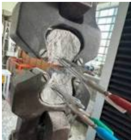
Figura 4-67. Falla espécimen BEM 0.5 % MWCNT.
