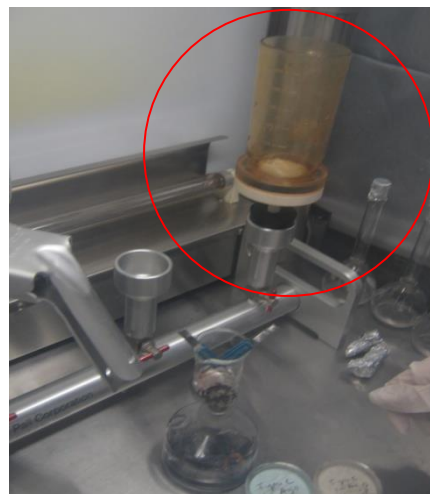
Foto 8. Sistema de filtración y embudo portafiltros
