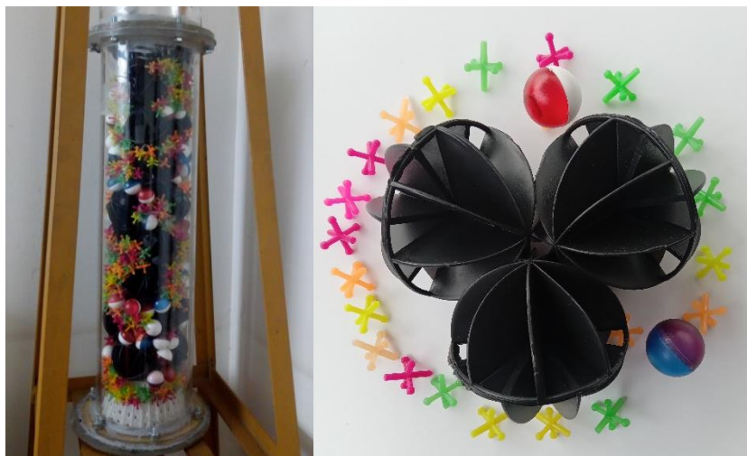
Figura 4-4: Relleno plástico del estrato filtrante
