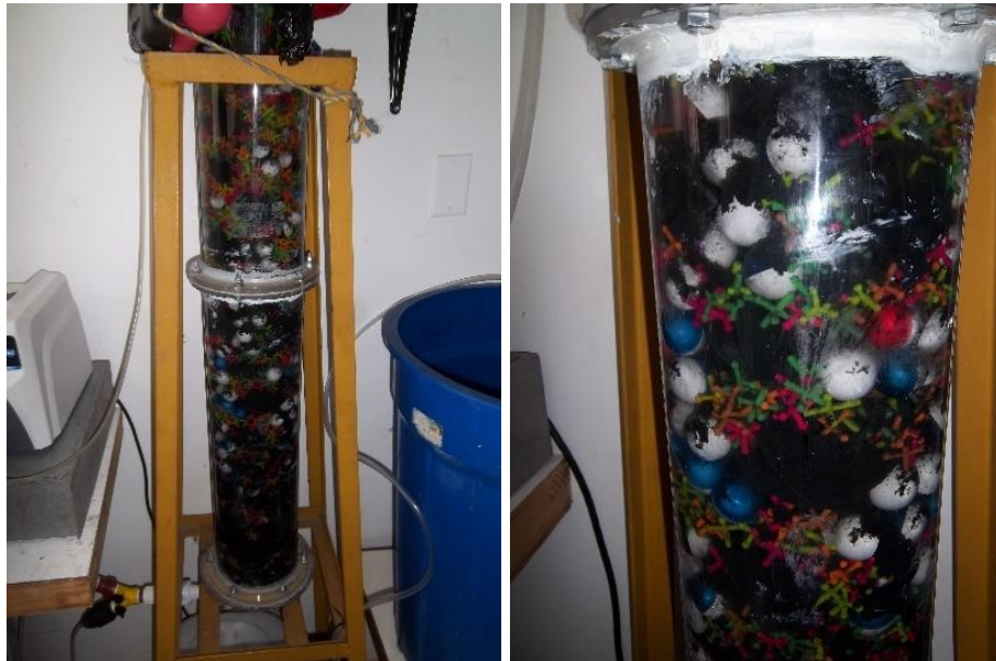
Figura 5-1: Formación de la biopelícula – Fase inicial
