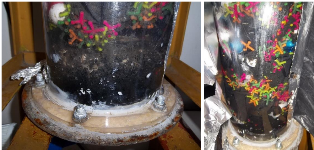
Figura 5-2: Formación de la biopelícula – Fase estable
